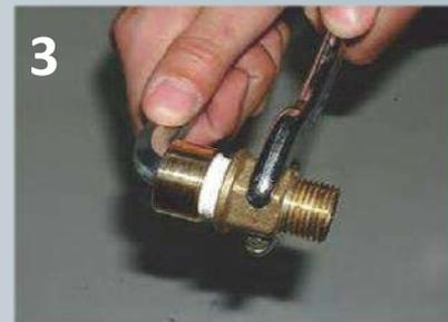
Foto n° 1 - Coloque una capa de teflón o similar para permitir un mejor sellado en la unión.
